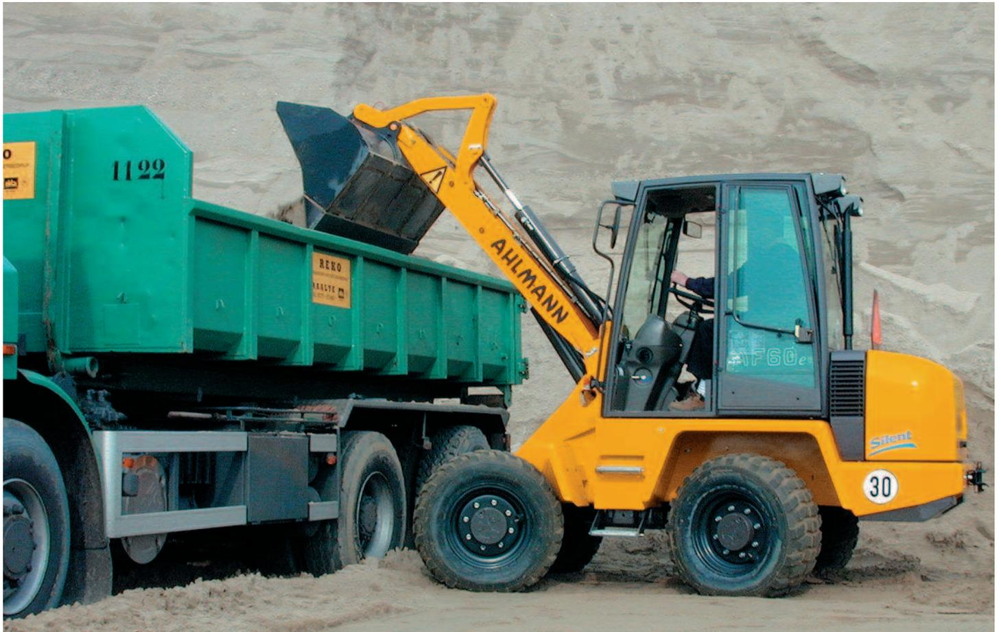
Durch den einteiligen Starrrahmen in Verbindung mit der Allradlenkung ist der AF 60e unübertroffen standsicher. Beim Einlenken bleibt die Lage des Schwerpunktes unverändert. Damit steht dem Bediener die volle Nutzlast unter allen Einsatzbedingungen zur Verfügung. Alle Wartungspunkte sind optimal zugänglich. Lange Motor-Wartungsintervalle von bis zu 1.000 Betriebsstunden garantieren niedrige Unterhaltskosten.
