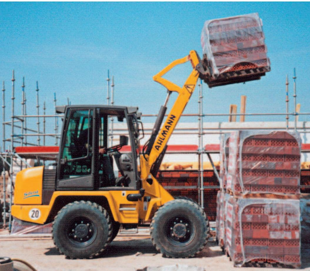
Der Ahlmann AF 60e ist ein extrem wendiger, allradgelenkter Frontlader. Er benötigt nur einen minimalen Wenderadius von 2,77 m. Durch seine kompakten Abmessungen ist er auch für Einsätze in engen Baustellen optimal geeignet. Mit einer Breite von 1,65 m ist er zudem absolut gehwegtauglich.
