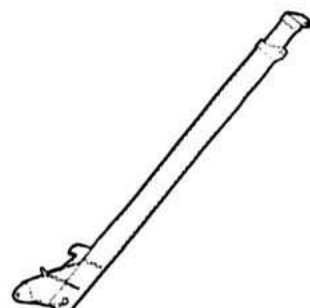
Kranarm* hydrauliskt utskjutbar 1,2 m.
