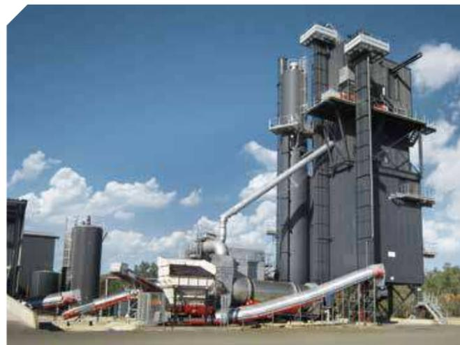
Die Asphaltmischanlage kann mit einem Kaltrecycling-Zugabesystem ausgestattet oder später nachgerüstet werden. Die multivariable Zugabevariante erzielt eine RC-Quote von bis zu 40 % und ist dabei sehr material- und komponentenschonend.
