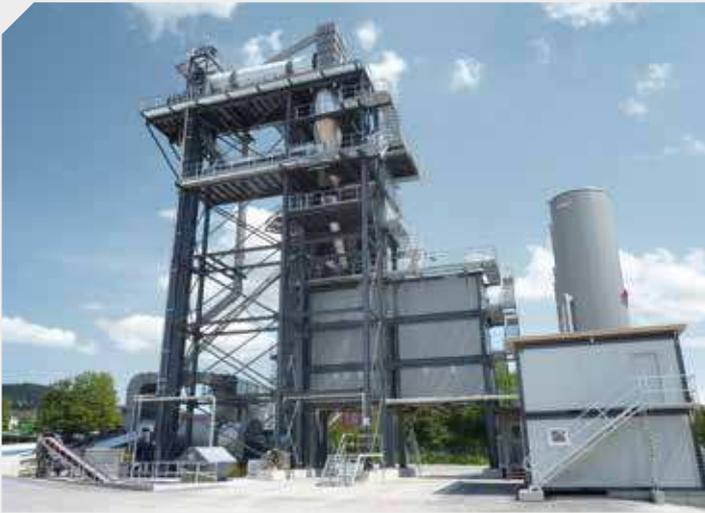
Последующее дооснащение завода системой загрузки горячего асфальтогранулята. Благодаря параллельному барабану процентная доля асфальтогранулята достигает 70 %.
