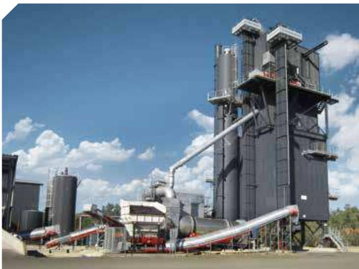
Асфальтобетонный завод может быть оснащен системой холодного ресайклинга или в любое время дооснащен ею. Комбинированная подача позволяет увеличить процентную долю асфальтогранулята до 40 %; при этом обеспечивается очень бережное отношение к материалу и компонентам.
