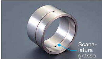
La boccola HN con olio ad alta viscosità è presente presso ogni giuntura per ridurre il consumo di grasso, prolungare gli intervalli di lubrificazione (da 100 a 500 ore) e aumentare la durabilità.
