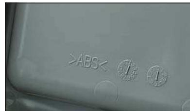
Circa il 95% della serie ZW è riciclabile. Tutti gli elementi in resina sono contrassegnati per agevolarne il riciclaggio. La macchina è assolutamente priva di piombo. Il radiatore dell'acqua e quello dell'olio sono realizzati in alluminio e i cavi sono tutti senza piombo. Per i siti in cui è necessaria particolare attenzione per l'ambiente è inoltre disponibile olio idraulico biodegradabile.
