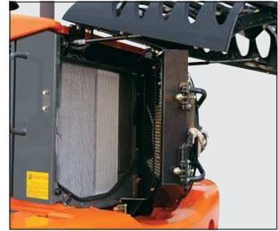
La rotazione della ventola di raffreddamento ad azionamento idraulico con sistema di rilevamento della temperatura è di serie. Anche la ventola può essere aperta per agevolare la pulizia.
