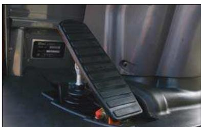
L'operatore può facilmente controllare la velocità di traslazione con il pedale modulabile, a prescindere dal pedale dell'acceleratore, regolando la portata della pompa idraulica. Ciò semplifica il posizionamento nelle operazioni di carico.
