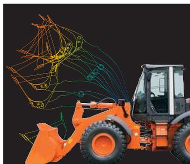
Con il nuovo circuito idraulico parallelo / tandem è possibile manovrare contemporaneamente braccio di sollevamento e benna. Si tratta di una nuova funzione che offre un incremento dell'efficienza di carico e scavo.
