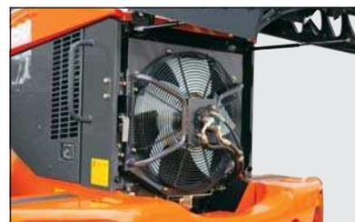
La velocità della ventola può essere regolata in base alla temperatura del fluido, per raffreddare efficacemente refrigerante e olio idraulico. Il risultato è una maggiore durata di servizio dei componenti e un minore consumo di carburante. Per agevolarne la manutenzione, la ventola è separata dal motore.
