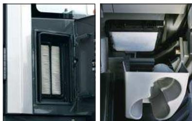
Il filtro dell'aria esterna può essere sostituito facilmente dalla cabina e il filtro di circolazione dell'aria può essere cambiato staccando semplicemente il portabicchiere.
