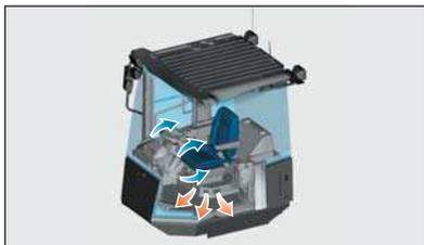
Il climatizzatore a due livelli provvede al condizionamento dell'aria ad altezza piedi e testa. Il volume e la direzione del flusso di aria possono essere regolati in base all'impostazione della temperatura. La cabina pressurizzata isola da polvere e detriti anche se l'ambiente esterno è polveroso.
