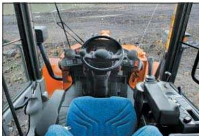
La cabina panoramica offre una visibilità quasi a 360°, con il cristallo anteriore più ampio e gli angoli posteriori della cabina privi di montanti. Le ruote anteriori sono sempre visibili all'operatore, migliorando la sicurezza e aumentando l'efficacia delle operazioni di carico.
