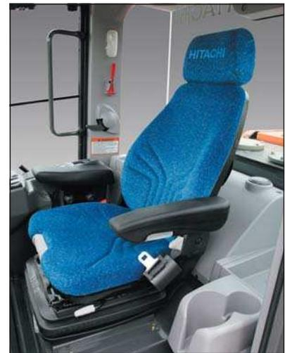
Il sedile a sospensione pneumatica consente molteplici regolazioni: peso-altezza, posizione avanzata-arretrata e angolazione dei braccioli, lunghezza e angolazione del cuscino del sedile, altezza e angolazione del poggiatesta e supporto lombare. Il sedile riscaldato è montato di serie.
