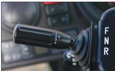
Il sistema HST completamente automatico viene utilizzato per la selezione di quattro velocità massime in base alle esigenze del lavoro. È possibile selezionare la velocità ottimale con meno scosse per una traslazione fluida.
