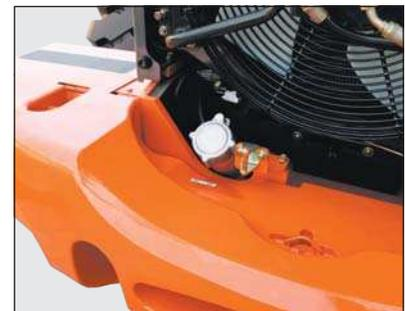
Il bocchettone di rifornimento del carburante consente di fare rifornimento da terra.
