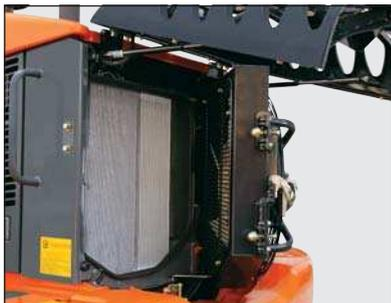
Per proteggerli dalla corrosione, i radiatori di acqua e olio sono realizzati in alluminio, invece che nel tradizionale acciaio o rame.
