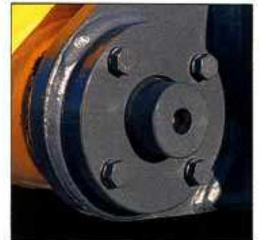
●バケットのガタを低減するクリアランス調整機構。
