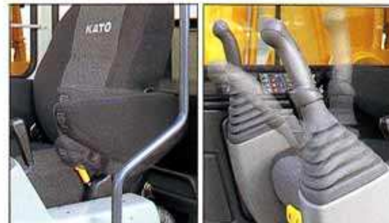
● オペレータの体格に合せたポジションが得られるレバー高さ・アームレスト角度調整機構。
