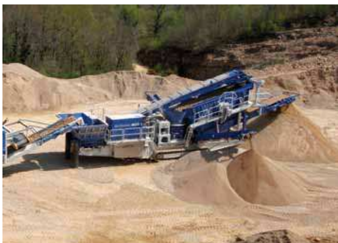
При замкнутом потоке материала MCO 9 S готовит три высококачественные фракции готового продукта.
