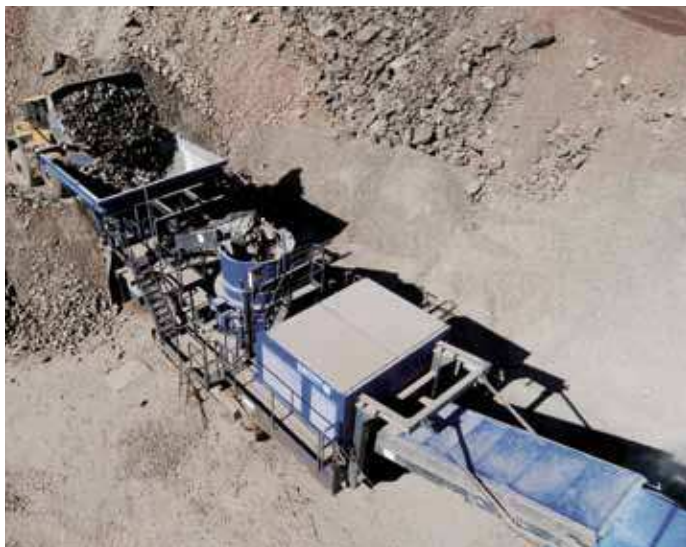
Установка MCO 11 может загрузаться колесным погрузчиком.
