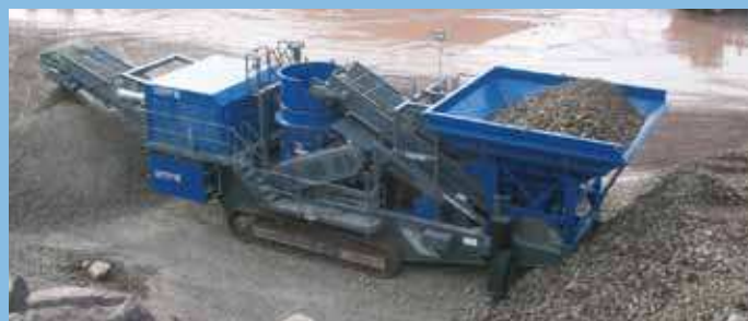
Технологически очень важной деталью установки MCO 11 является ее большой приемный бункер
