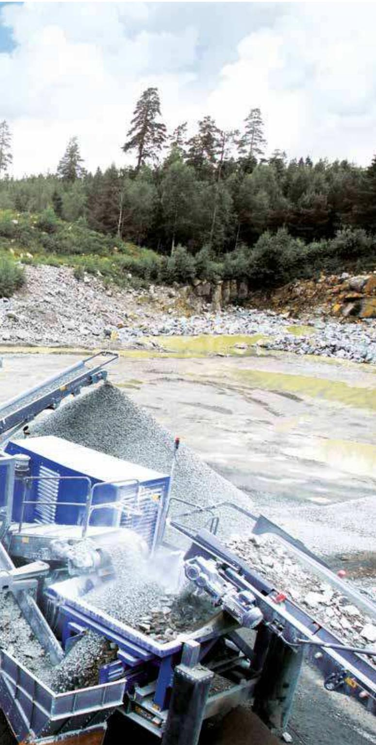
A instalação da britadeira de cone móvel MCO 11 S é considerada clássica na pedreira. Eficiente e potente, ela surpreende com suas vantagens como britadeira robusta que é com seu acionamento direto diesel-elétrico assim como conexão opcional a uma fonte de energia externa. Equipada com uma unidade de crivagem robusta e potente de três plataformas, é possível um circuito fechado. Desta forma se produz até três grãos finais qualificados.
