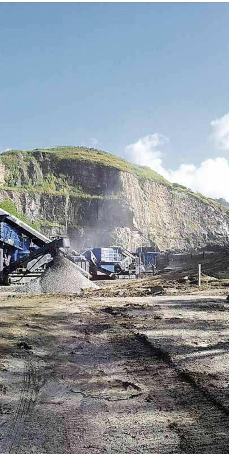
Há duas versões disponíveis da britadeira de cone móvel MOBICONE MCO 13/13 S. O MCO 13 pode processar tamanho de carregamentos máximos de até 330 mm.
