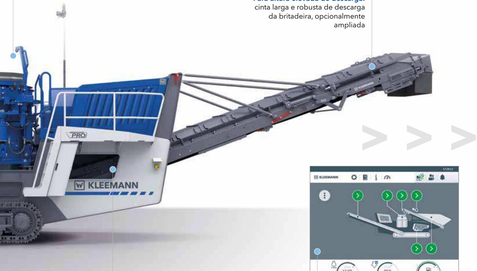
**Operabilidade simples sem necessidade de tempo de preparo:** ajuste da fenda confortável e automático através do painel de toque
