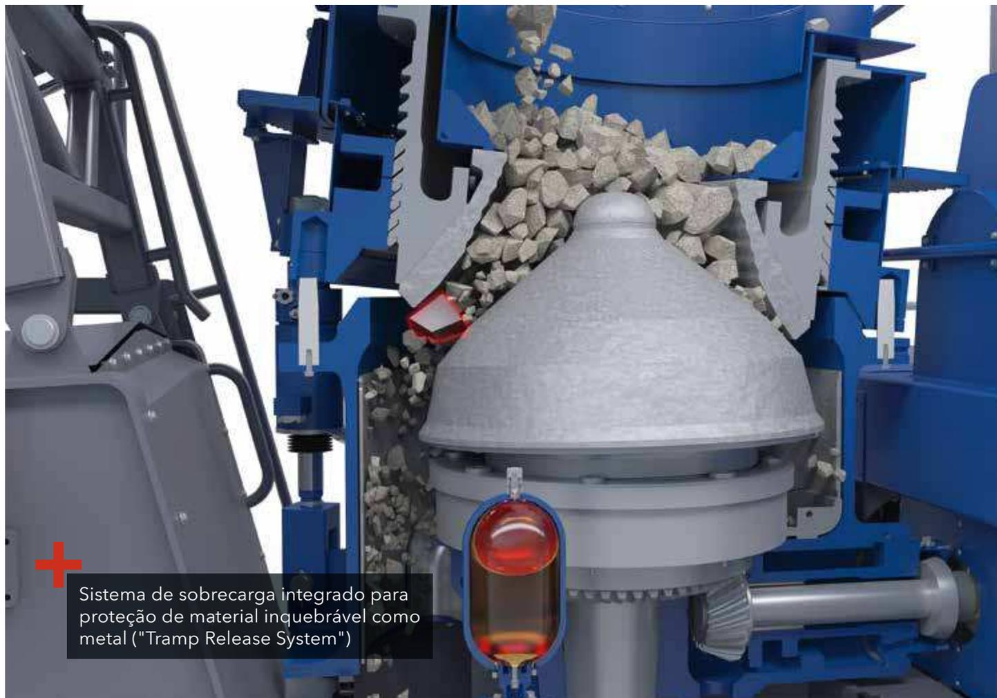
Sistema de sobrecarga integrado para proteção de material inquebrável como metal ("Tramp Release System")
