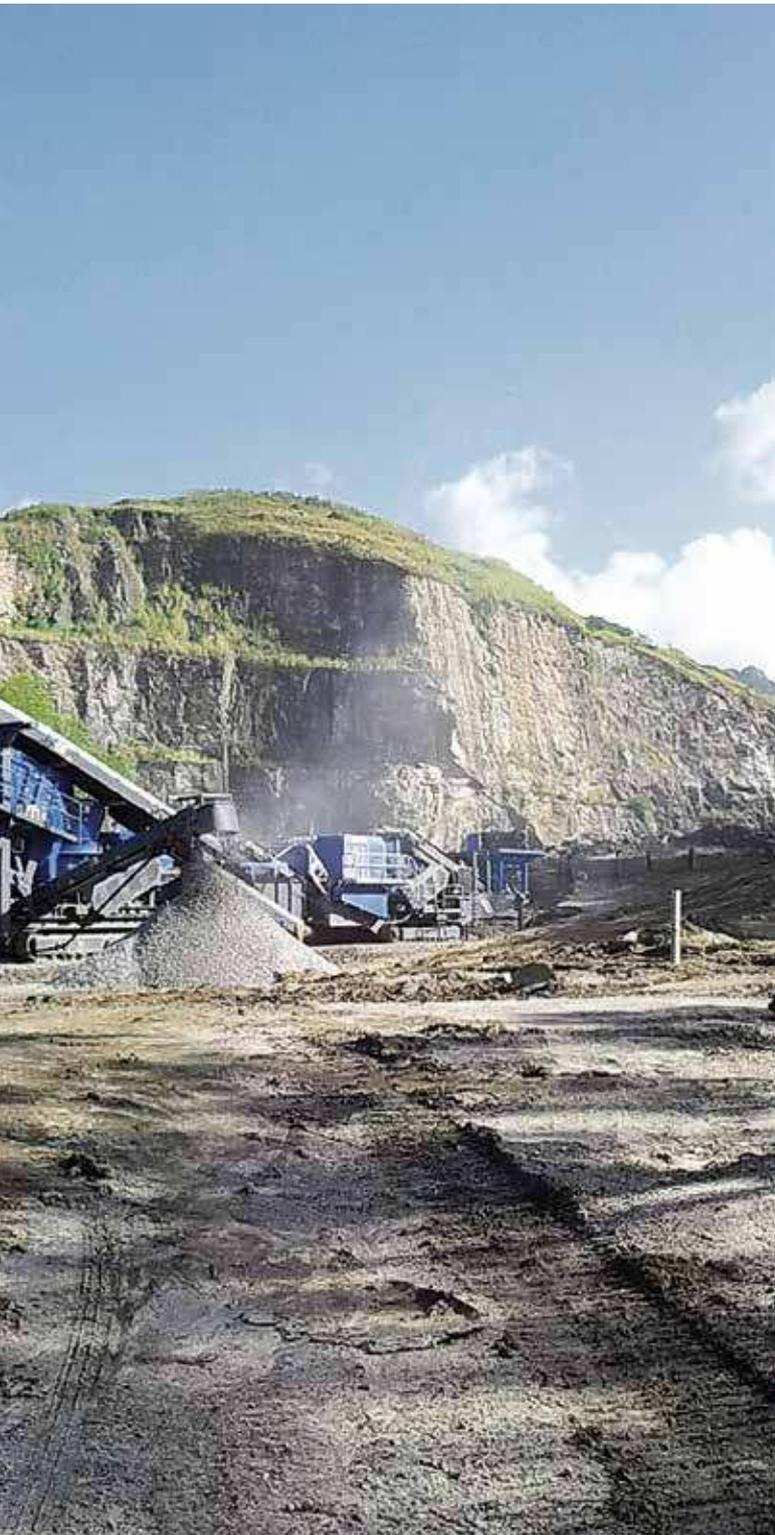
Las machacadoras de cono móviles MOBICONE MCO 13/13 S están a disposición en dos versiones. La MCO 13 puede procesar además tamaños máximos de entrada de hasta 330 mm.
