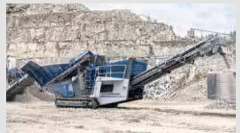
**Elevada productividad:** óptimo nivel de llenado de la machacadora mediante regulación de alimentación continuada CFS (Continuous Feed System)
