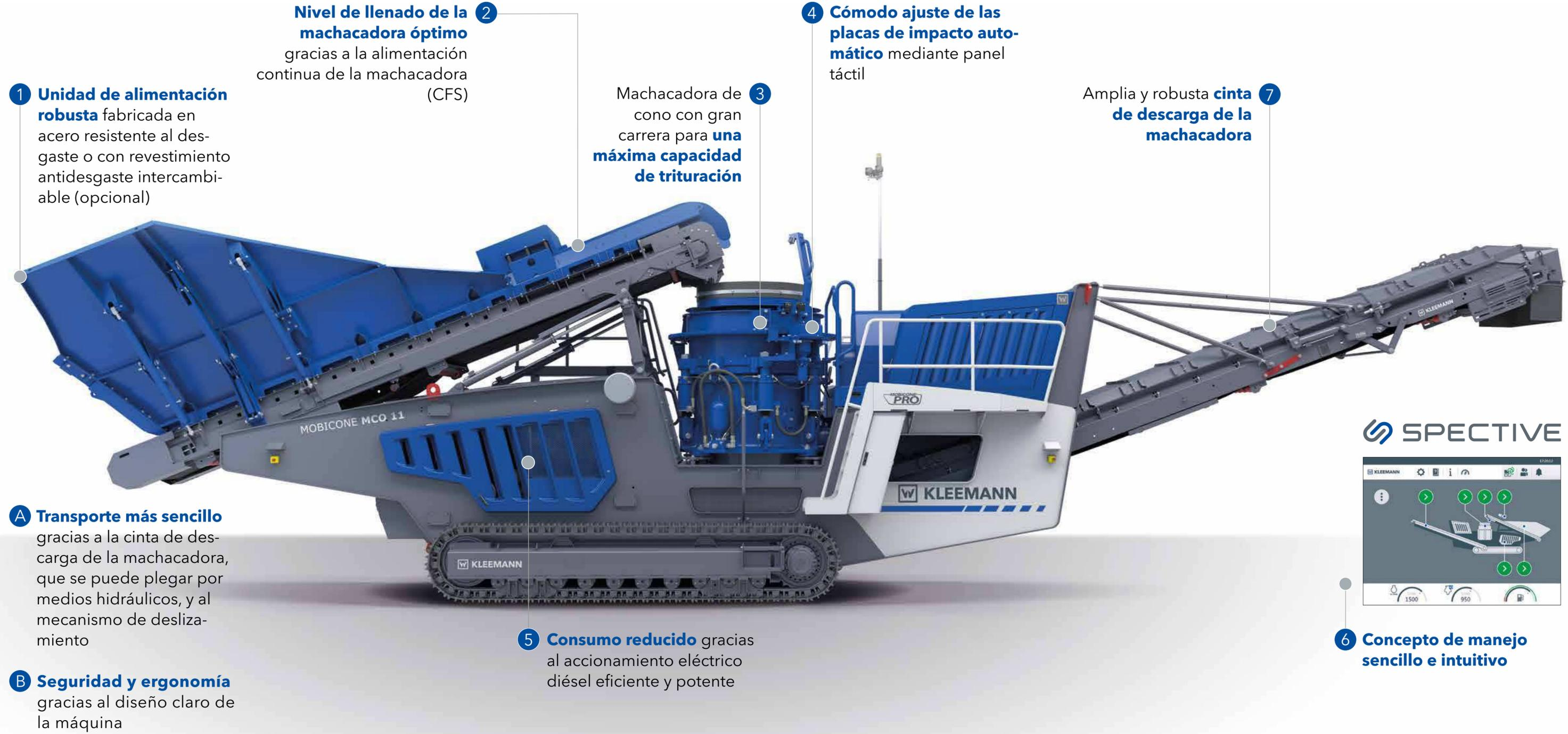
**1** **Unidad de alimentación robusta** fabricada en acero resistente al desgaste o con revestimiento antidesgaste intercambiable (opcional)
