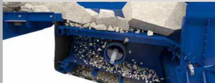
Независимый двухдечный грохот для предварительного просеивания
