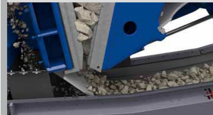
Отбойная плита и просторный канал для отвода материала
