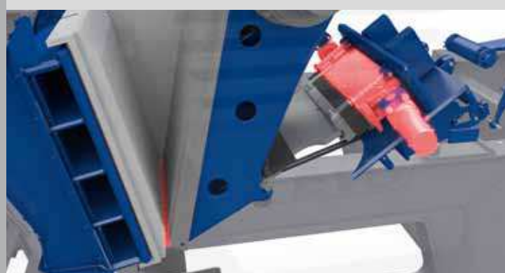
Регулятор ширины разгрузочной щели
