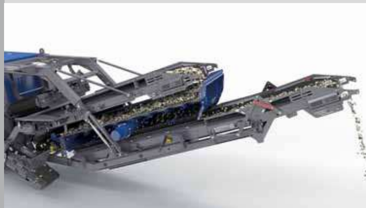
Criba vibrante con gran superficie de cribado
