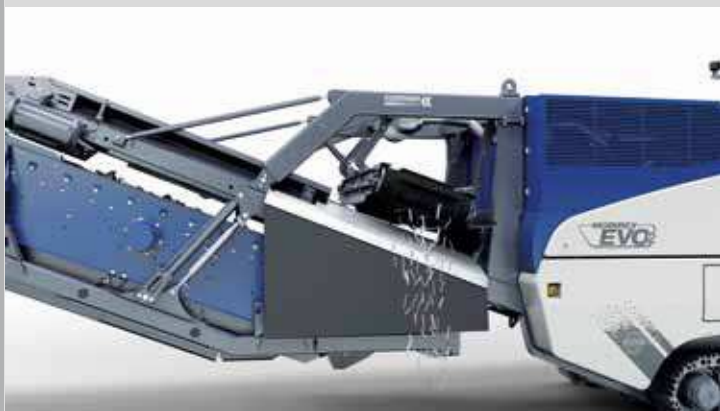
Efectiva extracción de metales/hierros a izquierda o derecha del equipo
