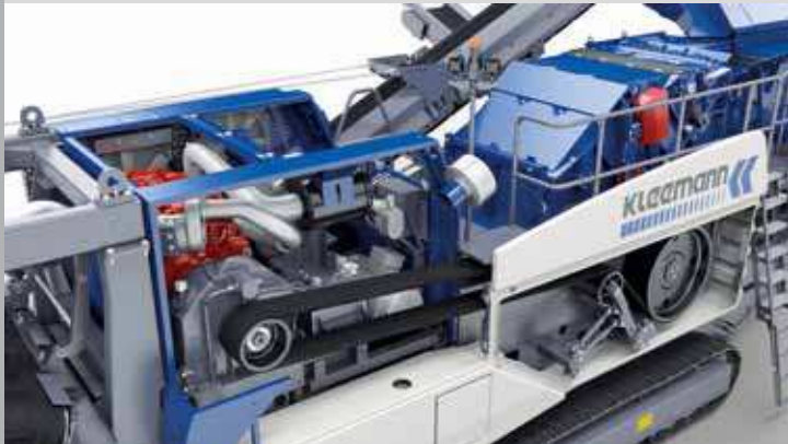
Accionamiento directo mediante acoplamiento hidráulico
