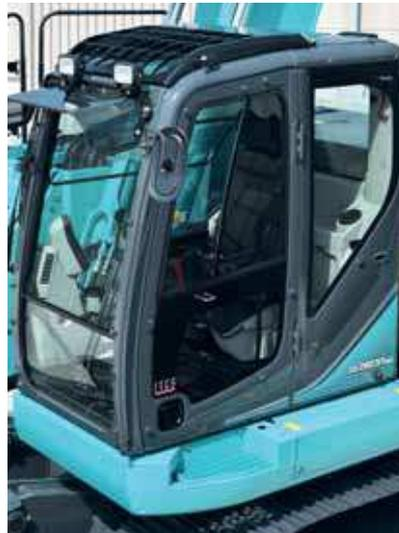
Die neu entwickelte, ROPS (Roll-Over-Protective-Structure)-konforme Kabine erfüllt die ISO-Normen (ISO-12117-2: 2008) und sorgt für mehr Sicherheit für den Bediener, sollte die Maschine umkippen.
