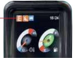
**H-Mode:** für schwere Arbeiten, bei denen eine hohe Leistung benötigt wird.
