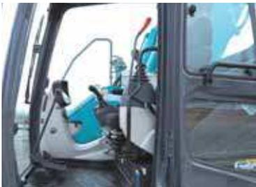
Einfacher Ein- und Ausstieg mit breiterem Kabinenzugang und in die Bedienhebel-Konsole integrierten Sicherheitshebel.
