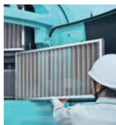
Beim Prüfen und Reinigen des Kühlsystems muss man mit verschiedenen Komponenten wie Kühler, Ölkühler und Ladeluftkühler umgehen, die alle auf verschiedene Art und Weise gereinigt werden müssen. Aber mit dem iNDr-Filter gibt es nur einen Filter an einer Stelle! Wenn bei der Überprüfung vor Arbeitsbeginn eine Verschmutzung des Filters festgestellt wird, kann dieser leicht und schnell gereinigt werden.
