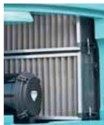
Außenluft wird direkt über den Lufteinlass durch den iNDr-Filter geleitet um Staubpartikel herauszufiltern. Der Filter hat ein 60er Maschennetz (bedeutet, dass 60 Löcher pro Zoll sowohl in horizontaler als auch vertikaler Richtung verteilt sind) mit einer breiten, gefächerten Frontfläche um Verstopfung zu vermeiden.
