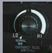
Für den unwahrscheinlichen Fall, dass ein ITCS-Steuersystem ausfällt, ermöglicht es die Notfall-Beschleunigungsfunktion dem Bediener, den Motor direkt zu steuern. Das Sicherungssystem der Maschine schaltet automatisch in den Notfallmodus.
