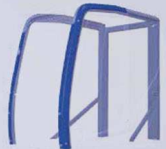
• Überrollschutz der Klasse 2 (FOPS-Schutzaufbau) (ISO 10262) serienmäßig.
