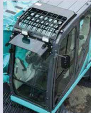
• Überrollschutz der Klasse 2 (FOPS-Schutzaufbau) (ISO 10262) serienmäßig.
