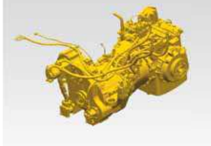
Měnič točivého momentu s automatickým uzamykáním
