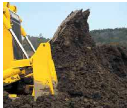
Radlice Sigmadozer® má vynikající schopnost udržování materiálu v radlici.
