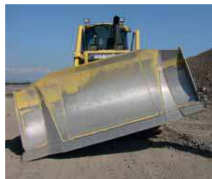
Hydraulicky nastavitelný sklon: 870 mm
