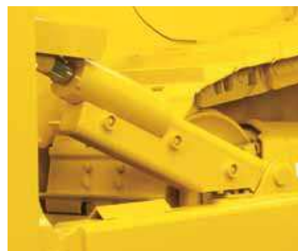
Hydraulické vedení je všude, kde je to možné, zabudováno přímo do konstrukce stroje.
