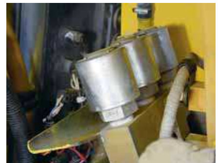
Entlüfterdosen erleichtern die Überprüfung und Reinigung (optional)
