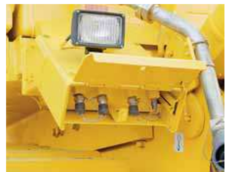
Leicht zugängliche Ablassventile mit Gewindestutzen (optional)
