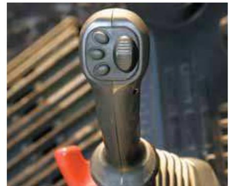
Joysticks mit Proportionalsteuerung für Anbaugeräte
