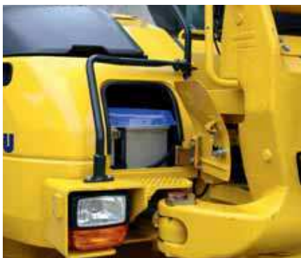
Tilgang til batteri fra bakkenivå
