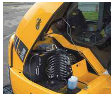
Capot direito para acesso fácil à válvula principal, depósito de combustível, depósito de óleo e caixa de ferramentas
