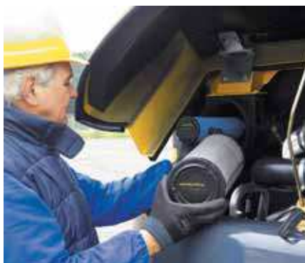
Capot traseiro para uma verificação rápida do motor e para acesso aos pontos de manutenção, que podem ser alcançados ao nível do solo
