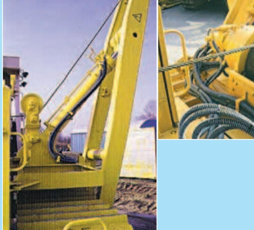
La flèche peut être réglée progressivement et avec précision grâce à un vérin hydraulique.
