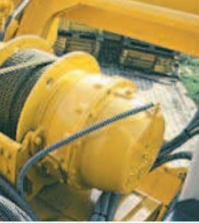
Le treuil à câble entraîné hydrauliquement permet une commande précise et sans à-coups du crochet de levage. L'abaissement de la charge s'effectue donc avec une puissance constante. Si le treuil est au repos, le frein de sécurité automatique s'enclenche immédiatement, ce qui bloque la charge et la maintient en toute sécurité.
