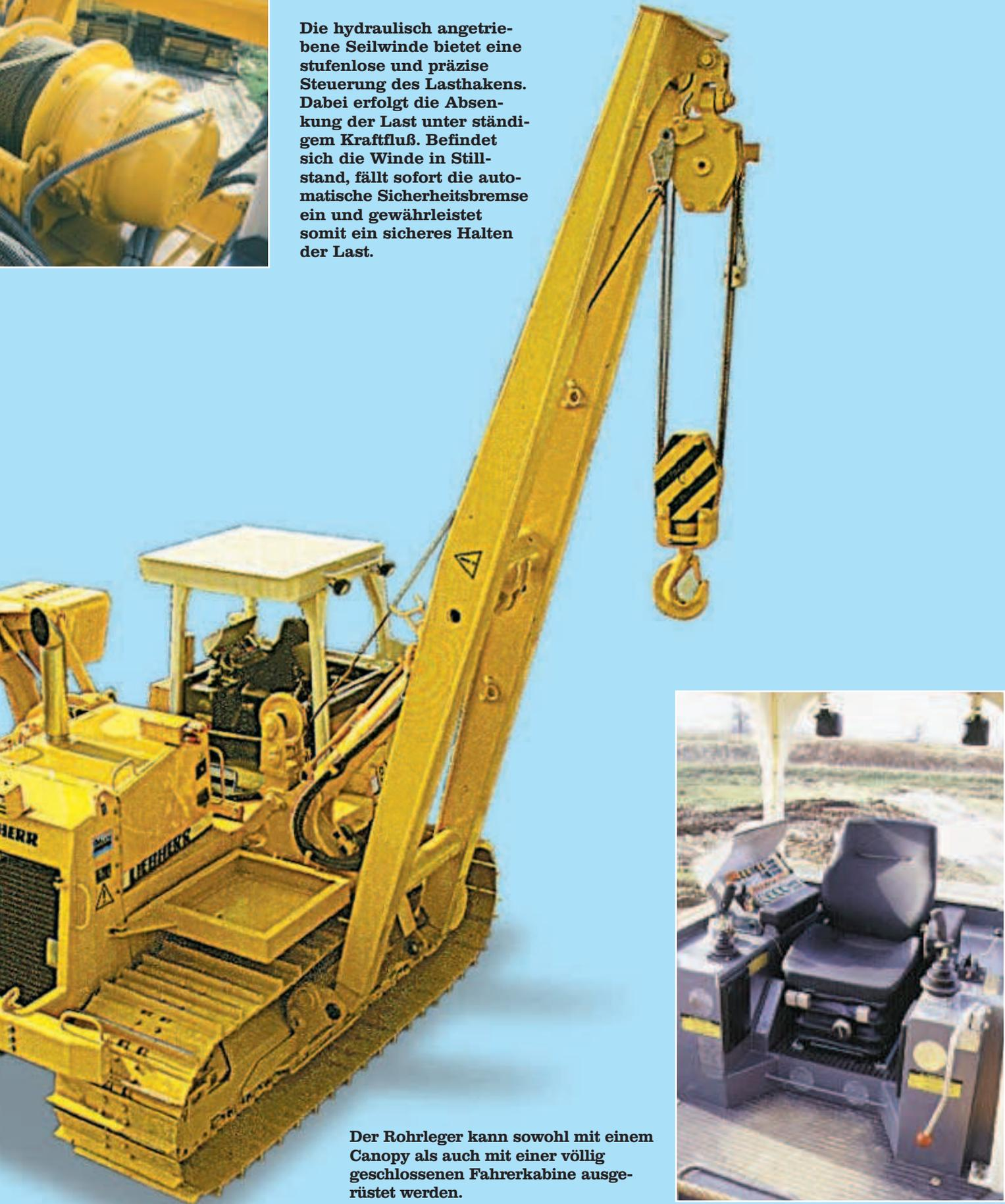
Der Rohrleger kann sowohl mit einem Canopy als auch mit einer völlig geschlossenen Fahrerkabine ausgerüstet werden.
