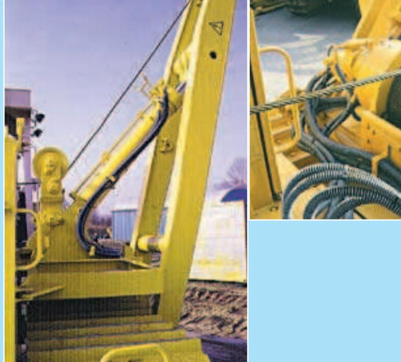
Der Ausleger kann über einen Hydraulikzylinder präzise und ruckfrei verstellt werden.
