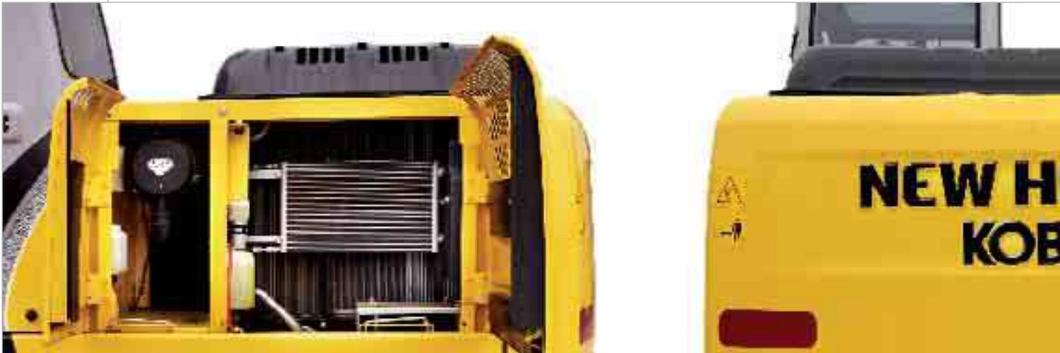
**D**ie vereinfachte Anordnung aller wichtigen Komponenten des Modells E195B von New Holland unter der rechten und linken Seitenabdeckung ermöglicht eine viel einfachere, schnellere und kostengünstigere Wartung und bietet einen weitaus besseren Wartungszugang. Alle Fächer sind sehr geräumig, und die meisten Komponenten sind so positioniert, dass sie vom Boden aus leicht erreichbar sind. **Ein elegantes und modernes Design in Kombination mit hochmoderner Technik.**
