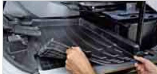
Die entfernbares zweiteilige Bodenmatte kann dank der Griffe leicht herausgenommen werden. Unter der Bodenmatte befindet sich ein Abfluss, der die Reinigung des Kabininnenraums erleichtert.
