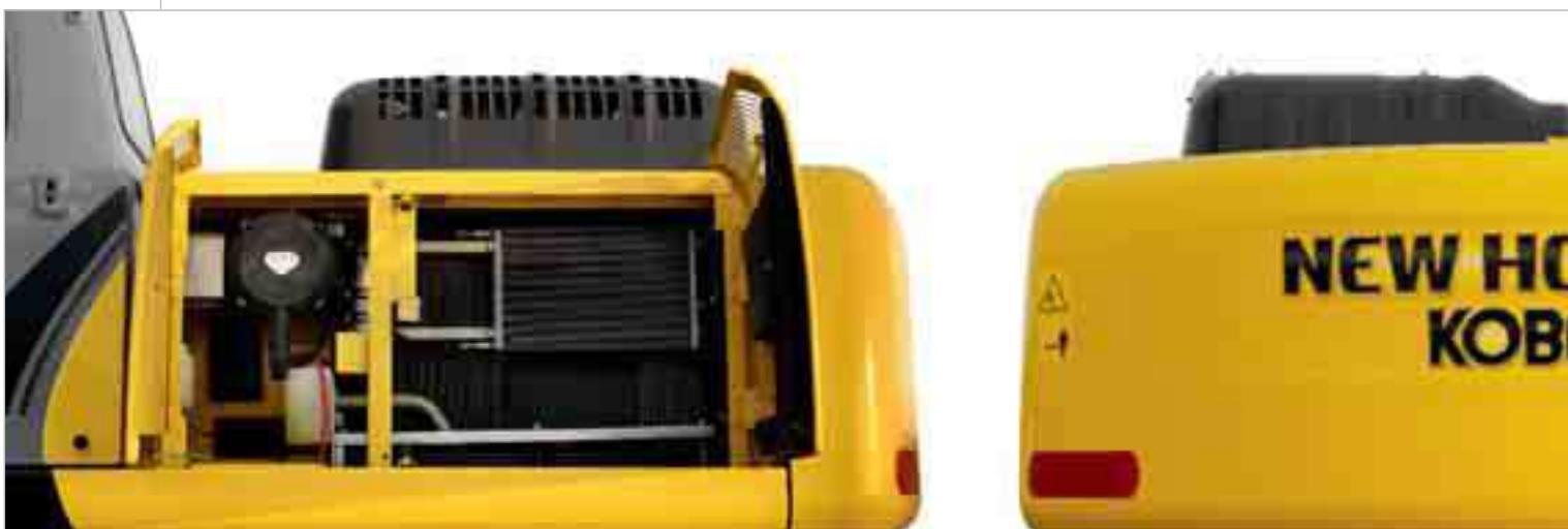
Die vereinfachte Anordnung aller wichtigen Komponenten des Modells E305B von New Holland unter der rechten und linken Seitenabdeckung ermöglicht eine viel einfachere, schnellere und kostengünstigere Wartung und bietet einen weitaus besseren Wartungszugang. Alle Fächer sind sehr geräumig, und die meisten Komponenten sind so positioniert, dass sie vom Boden aus leicht erreichbar sind. Ein elegantes und modernes Design in Kombination mit hochmoderner Technik.
