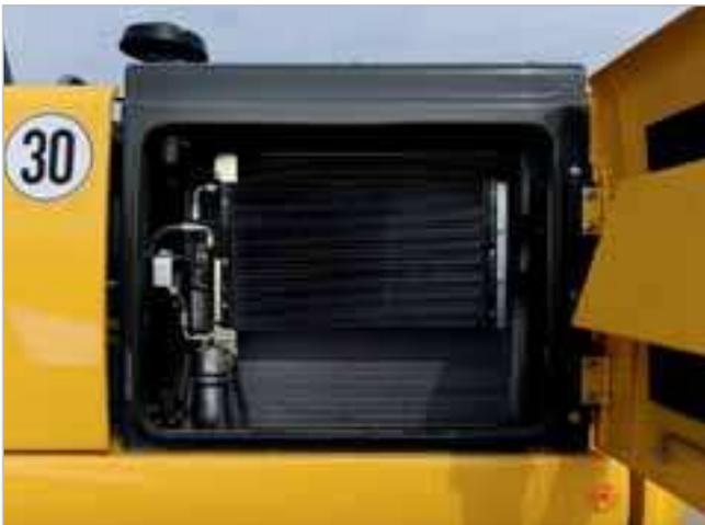
Die Komponenten des Kühlsystems (Lüfter, Hydraulikölkühler und Zwischenkühler) sind parallel angeordnet und erzielen so einen erheblich höheren Wirkungsgrad. Das erhöht die Zuverlässigkeit der Komponenten und erlaubt einen einfacheren Zugang für die Reinigung und Kontrolle.
