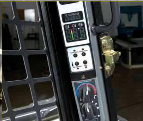
Novo painel lateral com controle de ar-condicionado, de fácil visualização.
