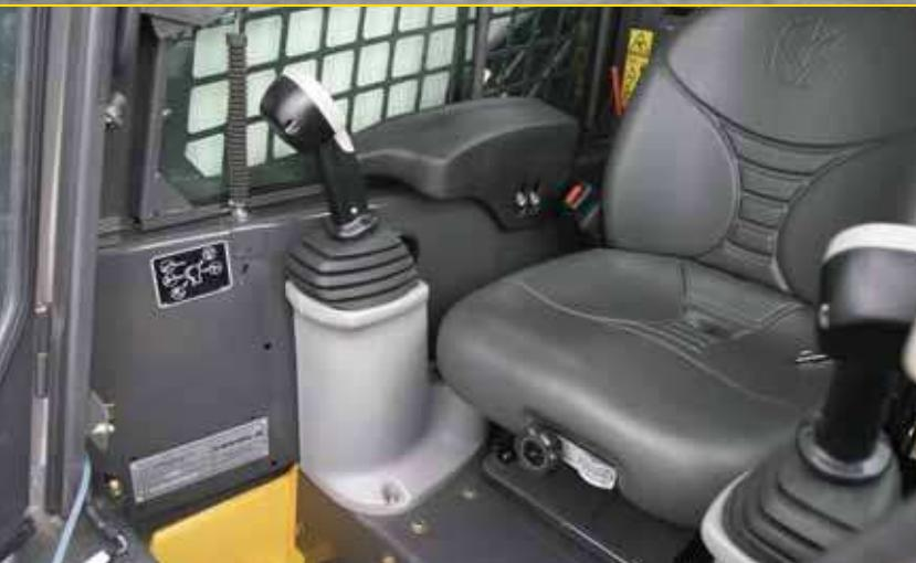
Assento com suspensão e descansos de braços ajustáveis permitem ao operador uma posição confortável de trabalho.
