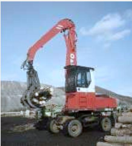
Sie können wählen zwischen dem hydraulisch hochfahrbaren Fahrerhaus und dem hochgezogenen Cockpit.
