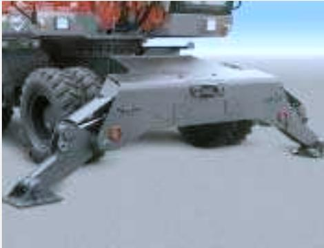
**Die breite Pratzenabstützung garantiert vorbildliches Standvermögen – auch bei großen Auslegerweiten.**
