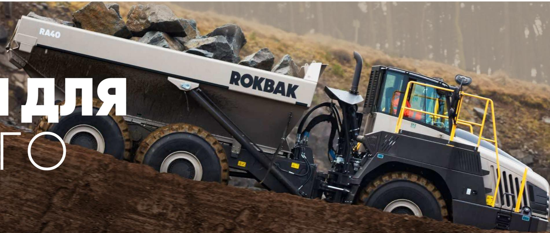
Для трудной работы нужны надежные машины. Наши надежные как скала самосвалы созданы для эффективной работы в любых ситуациях – на стройках, в карьерах, на горнорудных разработках. Усиленные мосты, трансмиссия с понижающими передачами и блокировка дифференциалов обеспечивают им лучшие в на рынке рабочие характеристики. Полный привод на все три моста гарантирует великолепное сцепление, снижает износ трансмиссии и пробуксовку колес. Ваш самосвал меньше изнашивается и перевозит больше груза.
