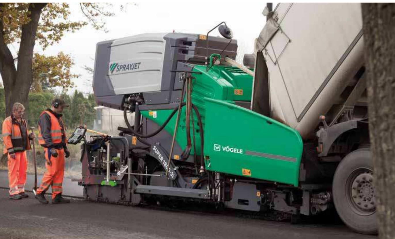
Der **SUPER 1800-3i SprayJet** verfügt in der Standardausführung über einen 2.100 Liter fassenden Emulsionstank. Die Befüllung des Tanks mit Bitumenemulsion sollte grundsätzlich mit heißer Emulsion erfolgen. Damit die Emulsion auf Verarbeitungstemperatur gehalten wird, verfügt der Tank über eine integrierte Heizung (2 x 7 kW). Zusätzlich verhindert die gute Isolierung Wärmeverluste.
