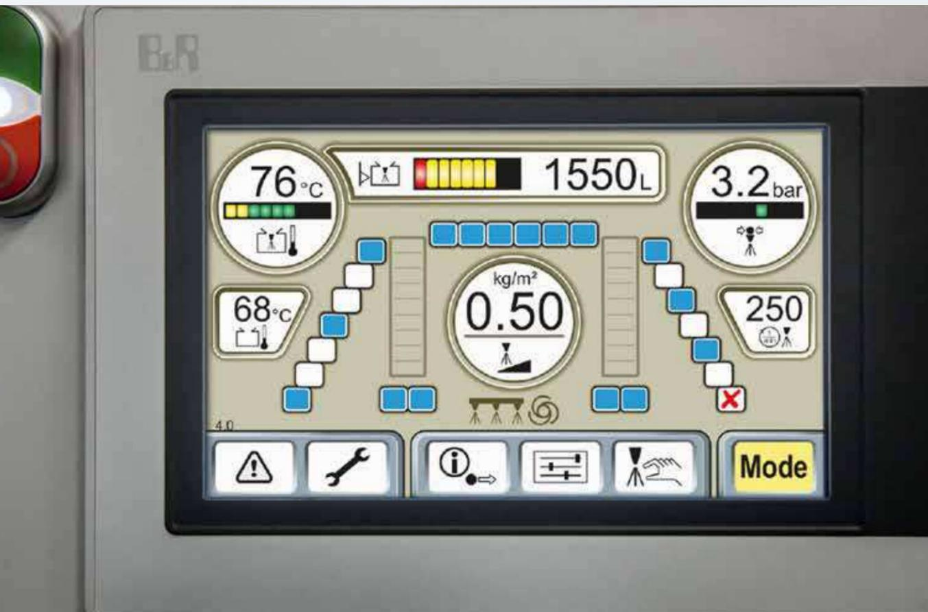
**Die gesamte Bedienung** des SprayJet Moduls erfolgt über das ErgoPlus 3 Display des Sprühmoduls. Der unter allen Witterungsbedingungen gut ablesbare Touchscreen gibt dem Bediener zu jedem Zeitpunkt volle Kontrolle über den Sprühvorgang.
