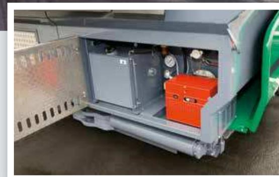
Ist der Fertiger mit dem Zusatztank ausgerüstet, erfolgt die Mischgutversorgung durch einen Beschicker. Ein Einfülltrichter im Tankmodul befördert das Material direkt auf die Kratzerbänder.
