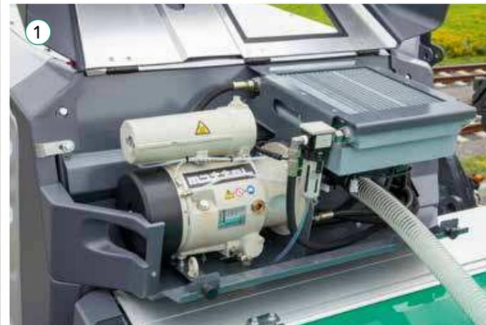
Das Öffnen und Schließen der Sprühdüsen geschieht pneumatisch. Dafür ist im SprayJet Modul eine Druckluftanlage integriert.
