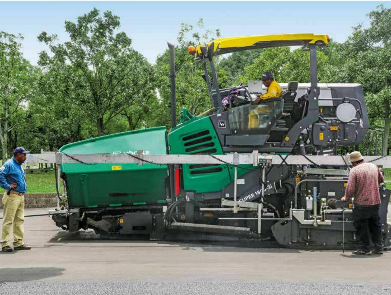
**Der SUPER 1800-3i SprayJet** kann jederzeit als Sprühfertiger genauso wie als konventioneller Standardfertiger eingesetzt werden. Vollkommen unabhängig von der Anwendung bietet die Maschine der Bedienmannschaft immer die große Vielfalt der Vorteile, die sich aus dem Innovationsvorsprung der „Strich 3“-Maschinengeneration ergeben.
