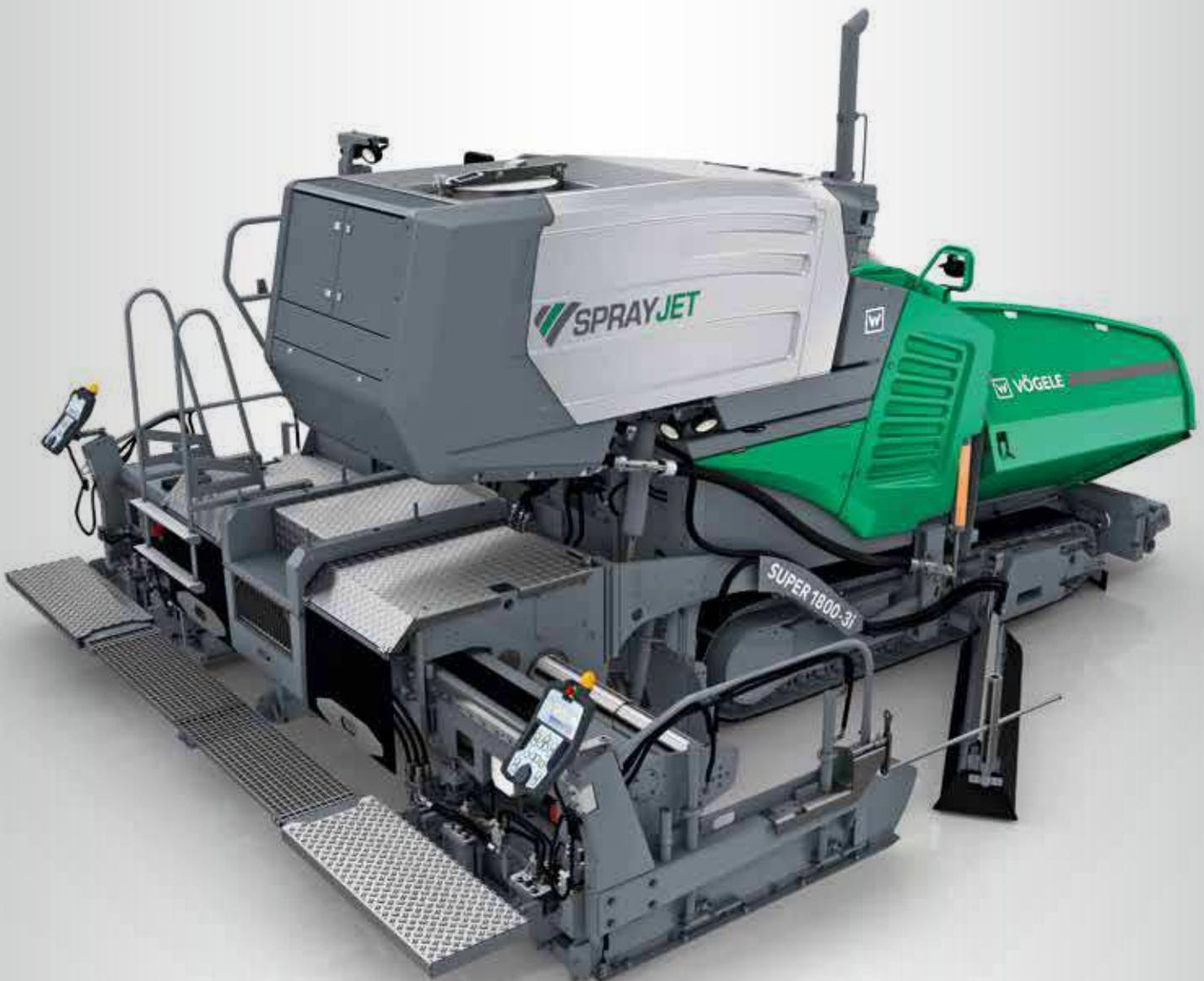
Maximale Sprühbreite 6,00 m
