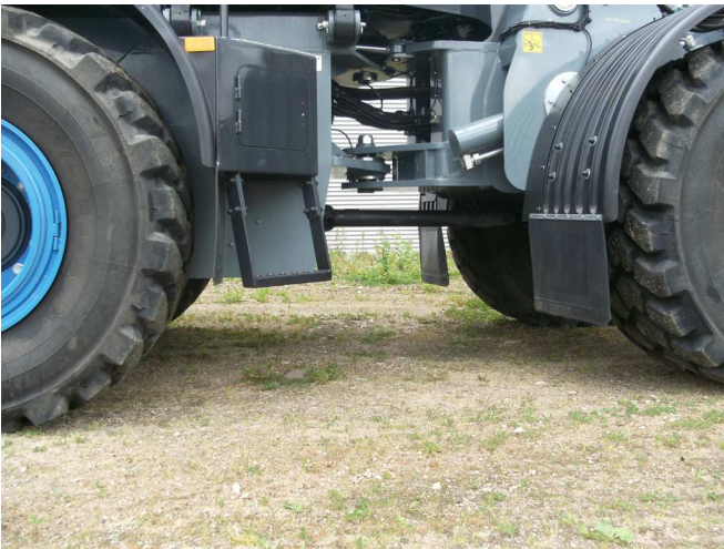
Hoge bodemvrijheid door doordacht knikpunt-systeem.
