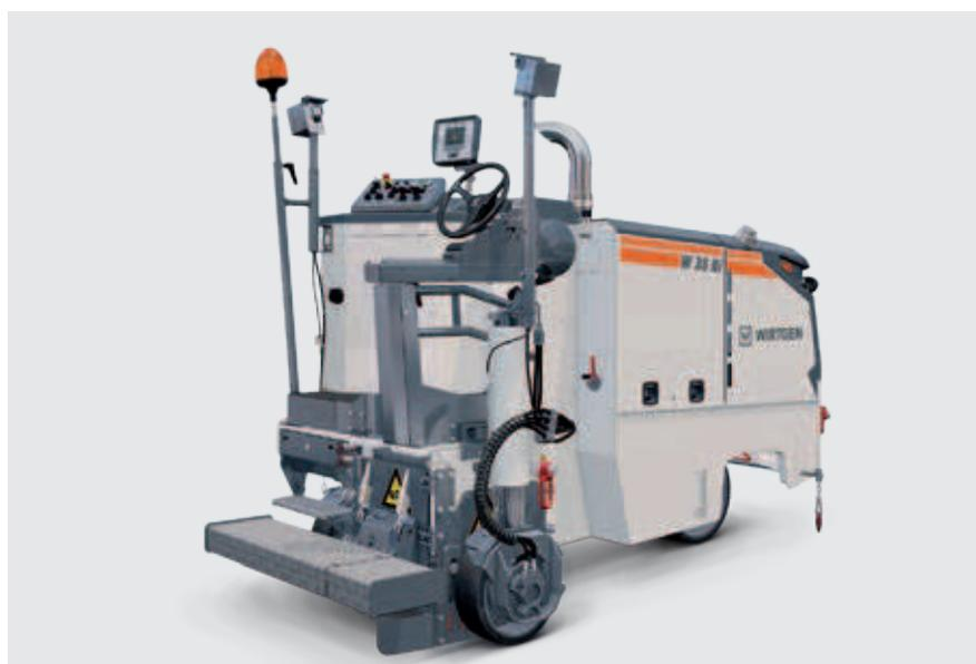
*Postazione di guida completa nella parte posteriore della macchina.*
